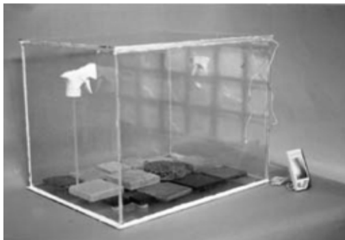
Fig 6. Cámara de ensayo a la acción de lluvia ácida para determinar la velocidad de deterioro en materiales empleados en las obras del Cementerio de La Recoleta. Muestras pre y post ataque (900 hs.) en Bronce estatuario y Mármol travertino
