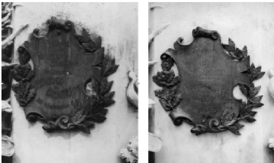
Fig. 8. Placa de bronce de base cobre pre y post limpieza. El tratamiento permitió recuperar la pátina original estable.
